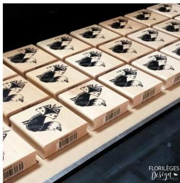
Étape N°11, Juillet-Août 2016 : assemblage manuel du caoutchouc + mousse + support bois, contrôle qualité final du tampon
