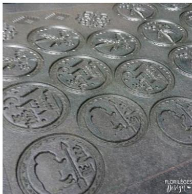
Étape N°4, Juin 2016 : moulage à chaud et démoulage d'une plaque de caoutchouc pour obtenir un motif en relief, avec un 1er contrôle qualité (élimination des motifs comportant une bulle d'air)
