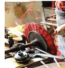
**Le retrait des aiguilles**, semi-mécanisé : quand le tissage de la trame est terminé, la machine s'arrête automatiquement. On démonte l'ensemble trame aiguilles qui est mis sur la tireuse. Les aiguilles sont retirées et remplacées par le fil de chaîne.
