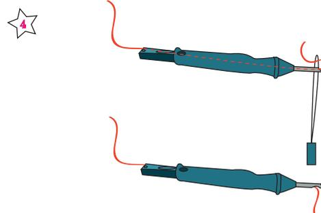
Insérez l'enfile-aiguille dans le chas de l'aiguille, côté plat. Enfilez une extrémité des brins de coton dans l'enfile-aiguille et sortez l'enfile-aiguille du chas en entraînant les cotons. L'appareil est prêt à fonctionner.
