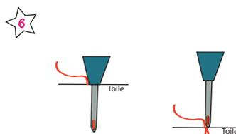
Enfoncez l'aiguille jusqu'à ce que le manche touche le tissu, puis remontez-la à la surface de la toile. Laissez glisser l'appareil vers la gauche, (environ deux brins de toile plus loin) et enfoncez l'aiguille à nouveau. Les bouclettes se forment de façon régulière sur l'endroit de l'ouvrage.
